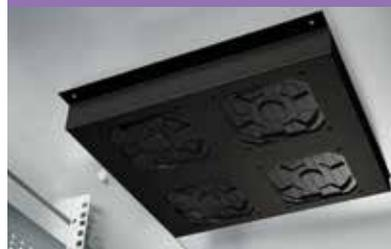
Afin d'assurer un flux d'air frais optimal, l'entrée d'air est assurée par 2 ventilateurs électriques au bas de l'armoire et l'aspiration par une unité de ventilation se positionnant sous le toit de l'armoire, équipée de 4 ventilateurs alimentés en 230 VAC.
