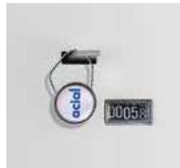
Le foncet, ou contre-porte, en tôle d'acier 20/10<sup>ème</sup> de mm, est plombé en deux points pour visualiser toute fraude sur le mécanisme. Un compteur d'ouverture à lecture horizontale à 5 chiffres, infalsifiable, actionné à la fermeture, est protégé par le foncet.
