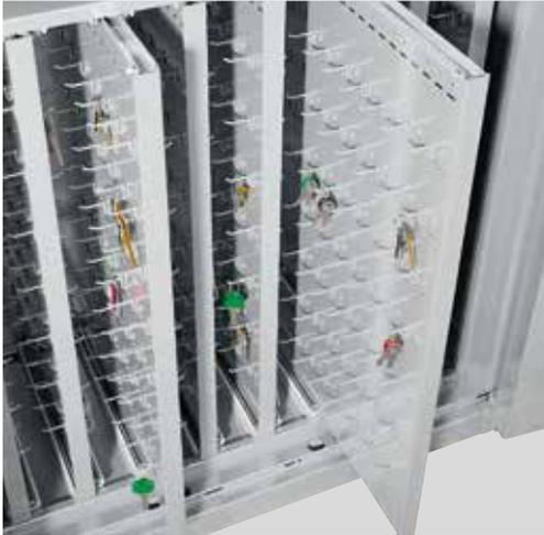
Rack pour le rangement des clés dans une armoire forte, tout acier, **équipé de 8 panneaux verticaux montés sur glissières à billes** permettant une extraction frontale et totale grâce à la préhension. Chaque panneau est perforé et **permet de recevoir 56 crochets en recto et 56 en verso**. Capacité maximale, par rack, 896 clés. Le crochet est amovible, d'une longueur de 50 mm et fourni en 750 exemplaires. Pour armoire forte C17/B90, maximum 2 racks.
